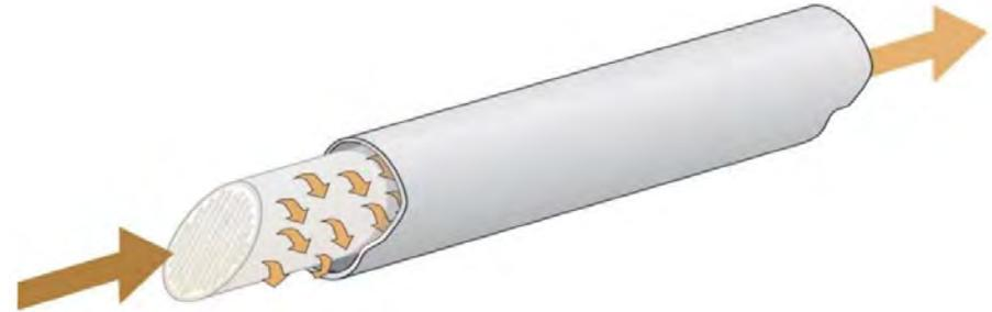
Funktionsprinzip eines Keramikmembranfilters
